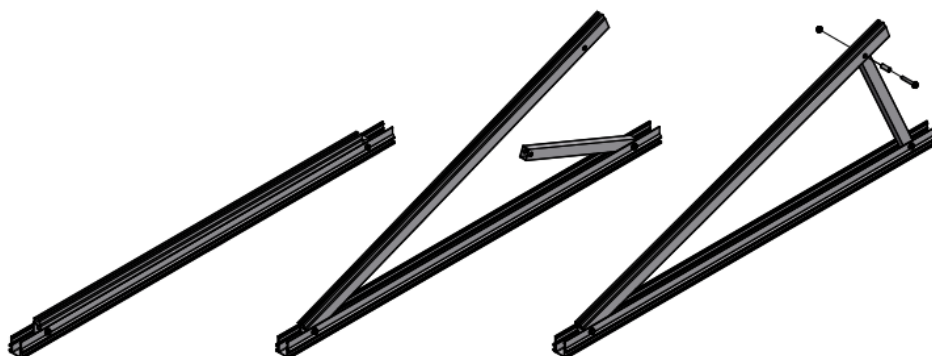
Abb. Montage Delta-Stütze mit einzelner Bodenschiene
