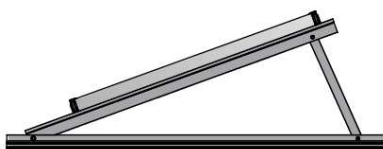
Abb. Modulmontage quer ohne Modulträgerprofil
