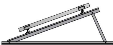
Abb. Modulmontage quer mit Modulträgerprofil
