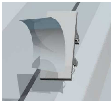
Bild 2: Abziehen der Schutzfolie
